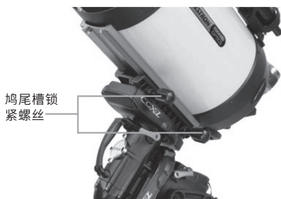
图 5 望远镜鸠尾板安装到位
