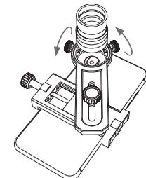
2. 取出目镜，放置目镜套环内，均匀旋转两边螺丝固定。
