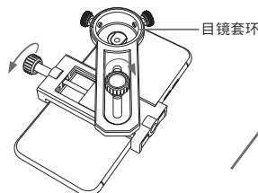
1. 取出手机支架，放置在合适位置旋转旋钮固定手机；调整目镜套环，套环中心完全对准手机摄像头后旋紧旋钮固定。
