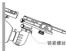
3. 将目镜放置天文望远镜设备上，旋转锁紧螺丝固定目镜。
