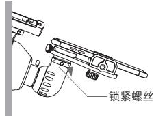
3. 将目镜放置天文望远镜设备上，旋转锁紧螺丝固定目镜。
