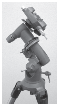
图 2-17 赤纬刻度盘顶部的赤纬锁旋钮 & 赤经刻度盘顶部的赤经锁旋钮
