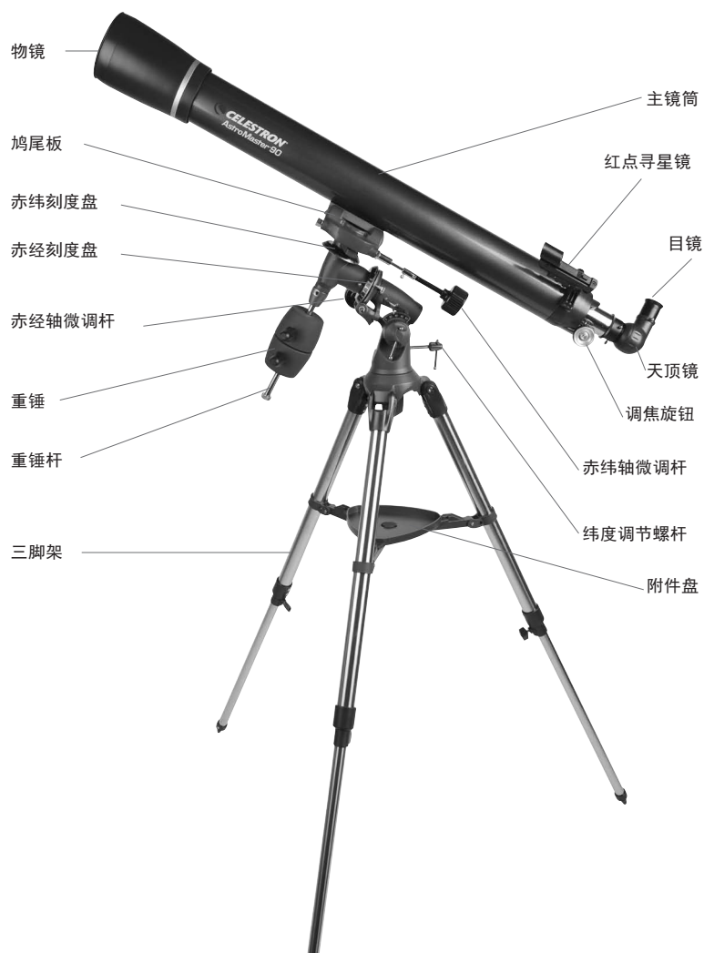
图 1-1 AstroMaster 90 EQ 折射式望远镜 AstroMaster 70EQ 类似
