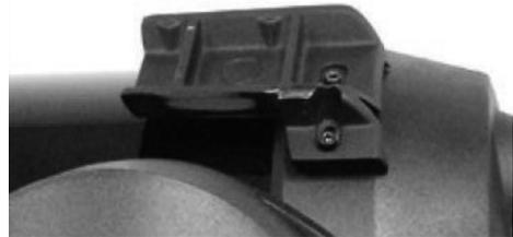
4. 把第 2 步移除的螺丝拧回原位，适度拧紧，固定住寻星镜支架固定架。固定架轴线尽量与镜筒平行。
