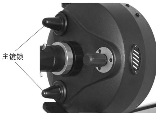
HD 型施密特-卡塞格林镜筒还有 2 个主镜锁，与调焦旋钮成 120 度，位于望远镜后面，见图。调焦前需要先松开主镜锁，逆时针转动主镜锁松开，感觉松开即可，不用转很多圈。完成调焦后，顺时针转动主镜锁适度锁紧，可以减少焦点漂移。
