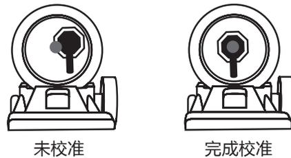
5. 不要移动主镜，调节红点的水平和高度调节纽，直到红点对准目标。
