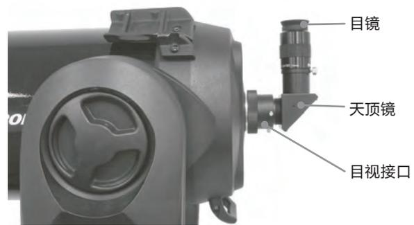
如果您希望改变天顶镜的方向，请松开锁紧螺钉，这样天顶镜就可以自由旋转。旋转到期望的位之后，再拧紧锁紧螺钉。
